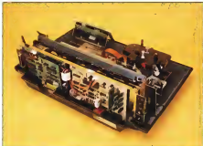
La testa percussiva della stampante aperta. È stato rimosso anche lo schermo metallico che nasconde l'elettronica. Si nota il sistema di schede RS-232 (retroscatto).
